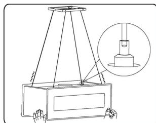
Вставьте другой конец троса в телескопическую натяжную головку корпуса подвески и отрегулируйте длину троса, чтобы вытяжка осталась в горизонтальном положении.
