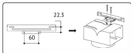
Поместите Т-образный кронштейн под внутренним воздуховодом и закрепите Т-образный воздуховод на кронштейне с помощью 2 винтов.
