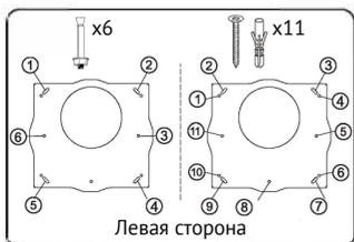
Расположите подвесную пластину на потолке, а затем отметьте положение отверстий для винтов. Подвесная пластина должна быть надежно закреплена на потолке.
