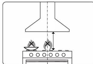
в. Для достижения наилучшего эффекта вытяжку следует размещать на расстоянии 650–750 мм над варочной панелью.
