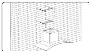
Отметьте положения и просверлите по 2 отверстия для каждого кронштейна воздуховода и затяните кронштейн винтами.
