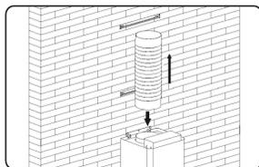
Прикрепите заслонку к воздуховыпускному отверстию вытяжки, а затем прикрепите трубу к воздуховыпускному отверстию, как показано на рисунке.
