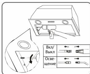
Снимите фильтр и ослабьте 2 винта на левой/правой стороне панели, отсоедините разъем лампы и выключателя, а затем уберите панель (как показано на рисунке).
