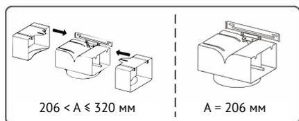
Выберите подходящий переходник в соответствии с размером воздуховода и закрепите его винтами ST4x8.
