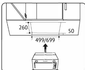
Перед установкой проверьте и сделайте отверстие в вашем кухонном шкафу соответствующего размера, чтобы оно соответствовало вытяжке (52 см/72 см).
