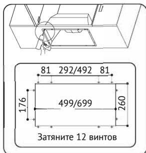
1. Закрепите корпус изделия в шкафу с помощью 12 винтов.
