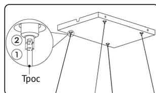
1. Вставьте один конец троса в телескопическую натяжную головку подвески, и трос будет прочно зафиксирован.
