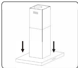
Снимите подвесной крюк, а затем сдвиньте нижнюю секцию вниз, пока она не упрется в основной корпус вытяжки.
