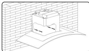
Перед установкой просверлите дополнительные отверстия 2x8 мм и закрепите винты и пластиковые дюбели.
