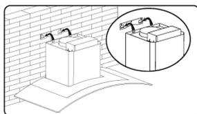
Поднимите вытяжку и повесьте ее на настенный кронштейн.
