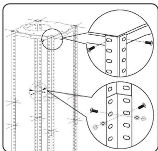
Закрепите уголки на монтажной пластине с помощью винтов 8\*(M5x10).
