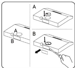
**Два способа вентиляции (А и Б)**
