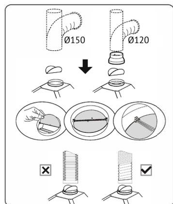
**Способ установки трубы диаметром 150 мм:** вставьте антивозвратный клапан, как указано на рисунке, и зафиксируйте гофротрубу.
