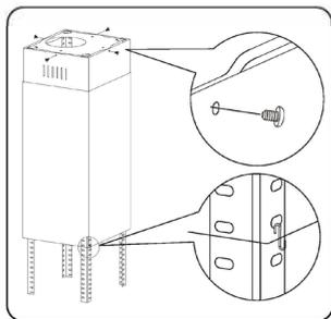
Если ваша вытяжка будет использоваться в режиме вытяжной вентиляции, на этом этапе вам следует подсоединить шланг воздуховода к потолочному переходнику.
