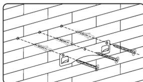
Просверлите отверстия 3x8 мм для крепления кронштейна. Прикрутите и закрепите кронштейн на стене с помощью винтов и пластиковых дюбелей, входящих в комплект.
