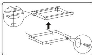
Закрепив кронштейна на потолке, закрепите крышку кронштейна с помощью 4 винтов ST4x12.
