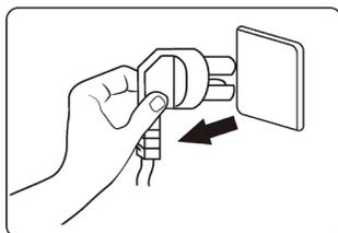
б. Перед установкой выключите прибор и отсоедините его от розетки.
